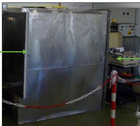
Figure 59 : Enceinte blindée contenant le transformateur 16 kV.
