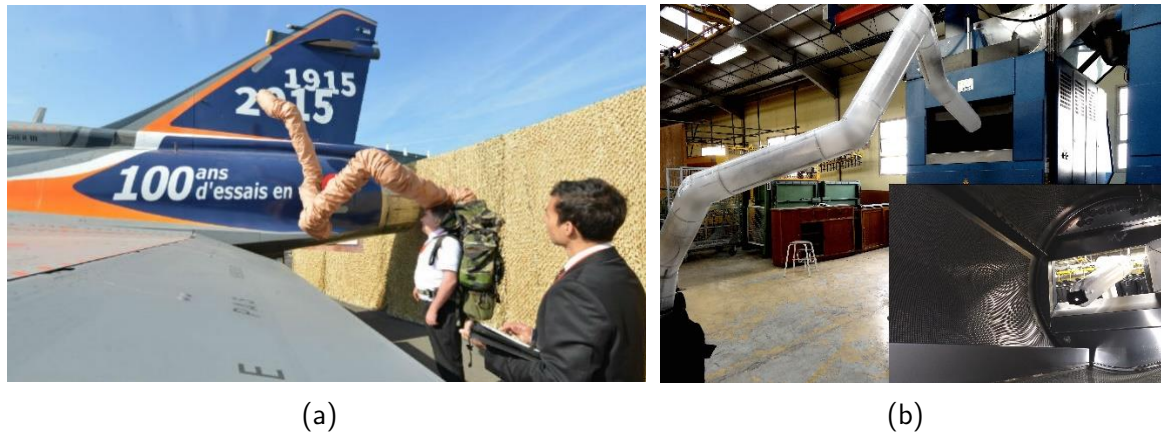
Figure 2 Démonstration du bras ultraléger gonflable (a) Démonstration du bras ultraléger gonflable dans l'inspection du fuselage d'un avion (b) Inspection en environnement industriel.
