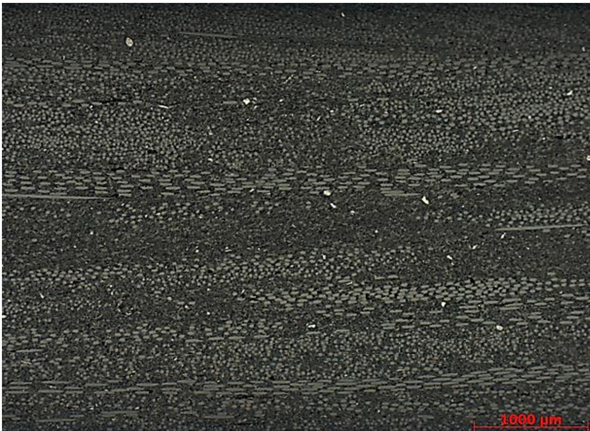
Figure II. 6 : image microscopique de la structure du matériau d'étude
