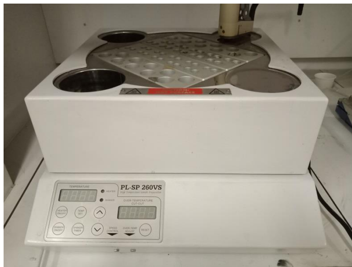
Figure II-3 : Photo de l'agitateur thermique permettant la dissolution des fibres de HT-PVAI dans le DMSO.
