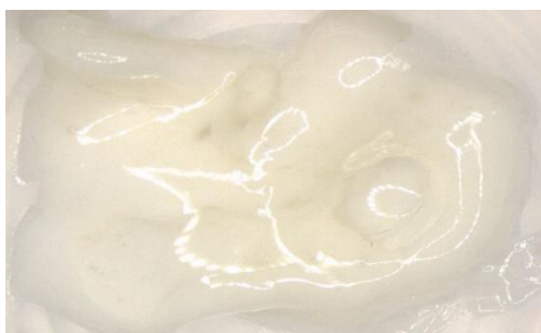
Figure IV-47 : échantillon trop fragile pour être manipuler après un test en immersion
