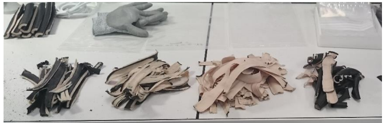
Figure II-30 : résultat de la découpe après passage de la jonction dans la pareuse
